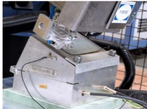
Abbildung 2: Prototyp des Druckkopfes beim Drucken von 3D-Strukturen
