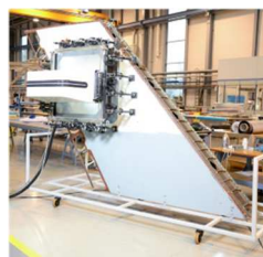
Abbildung 2: Fräsroboter an einem Seitenleitwerk
