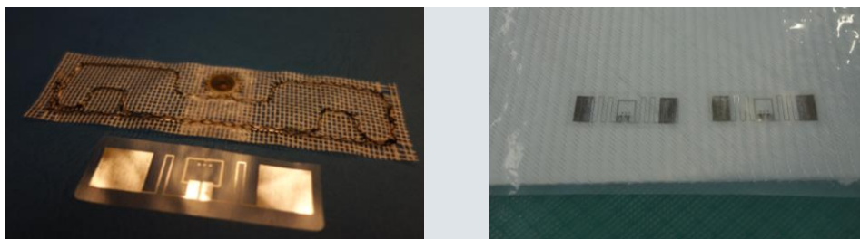
Links: Beispiele für verschiedene Sensorgeometrien Rechts: Sensoren auf Glasfaserge-webe
