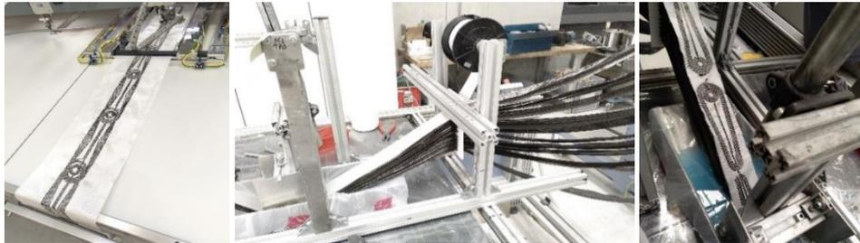
Verkettete TFP-Patch-Verstärkungen und Zuführung der Textilien in den Pultrusionsprozess
