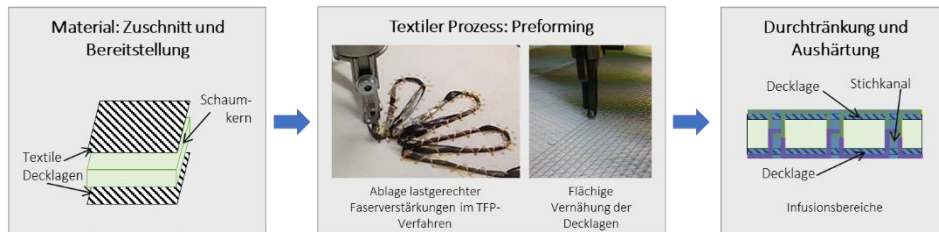
Abbildung 2: Prozesskette zur Herstellung lastgerecht verstärkter Sandwichstrukturen
