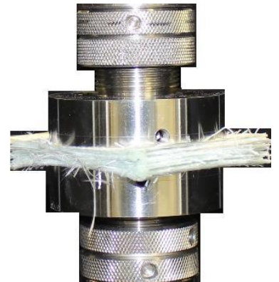
Kompaktierung eines Geleges in einer Universalprüfmaschine
