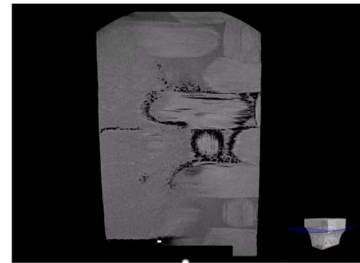
Delaminationen und Lufteinschlüsse im Overmolding-Bauteil sind zu erkennen (dunkle Bereiche).
