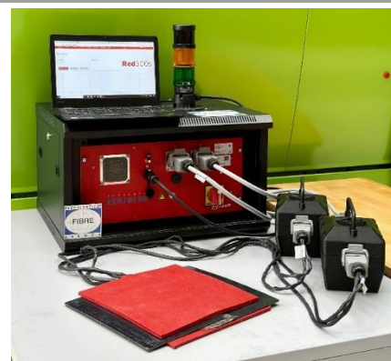
Flexible induktionsbasierte Erwärmung für die Reparatur von thermoplastischen Verbundbauteilen
