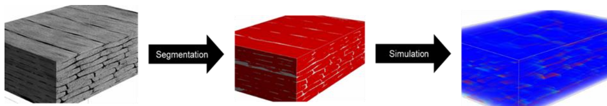
Abb.: Prozessschritte vom CT zur Flusssimulation
